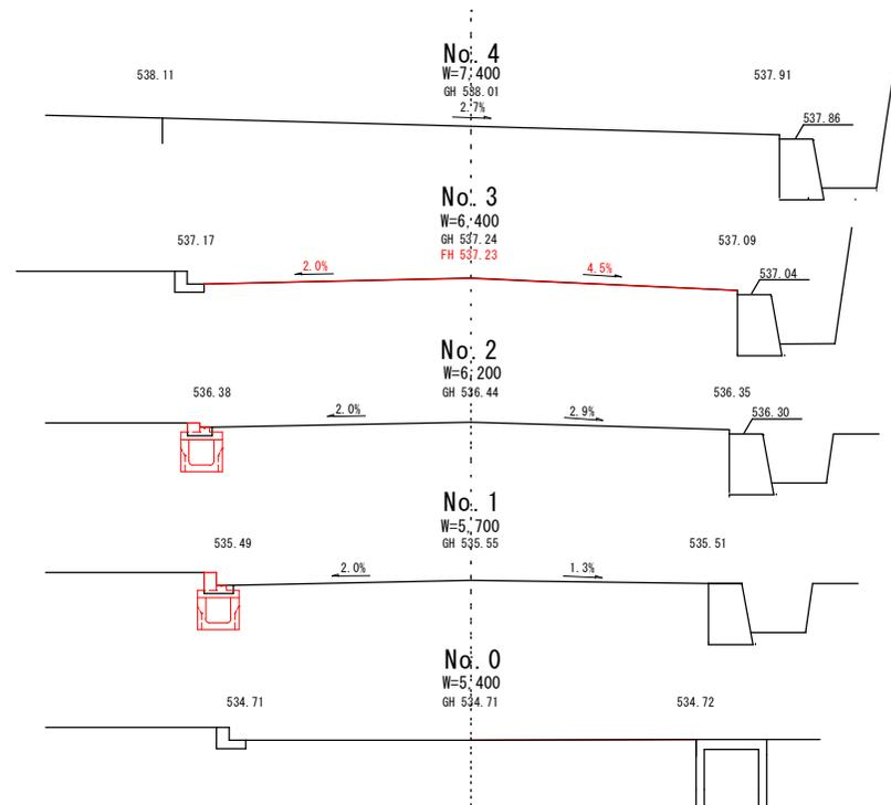
標準横断面図(側溝) S=1:20 (A4)
