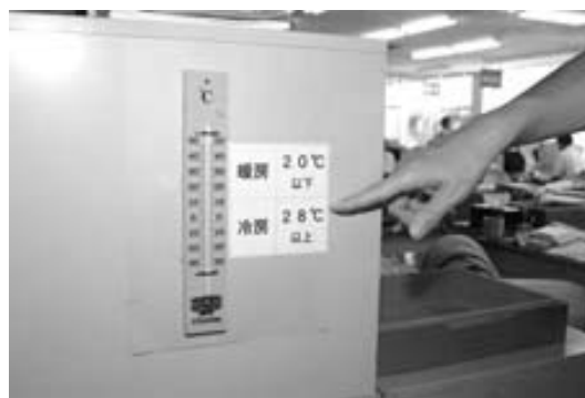
温度設定（冷房は28度以上、暖房は20度以下になるよう設定し、こまめに調整し冷暖房による環境負荷を低減）
