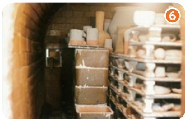
登り窯の窯詰め準備(窯内本棚づくり)。 毎年約300点の作品を入れています。
