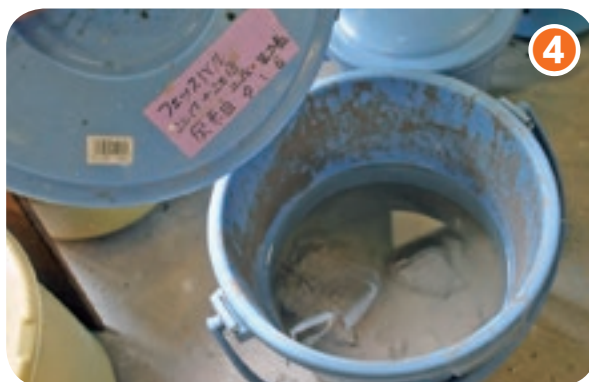
釉薬(ゆうやく)を作品一つひとつにかけます。釉薬はうわぐすりとも呼ばれています。原料は水と灰などです。
