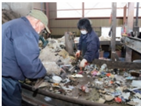
▲電球はリサイクルできないため、手作業で取り除いています
